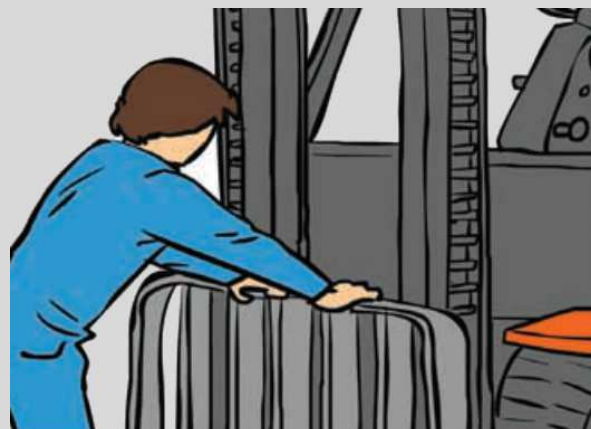
L'existence de fissures ou de déformations dans le dossieret de charge.
