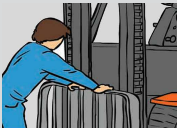
L'existence de fissures ou de déformations dans le dossier de charge
