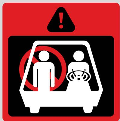
→ **IL EST INTERDIT** de conduire le chariot élévateur avec un deuxième occupant à bord
