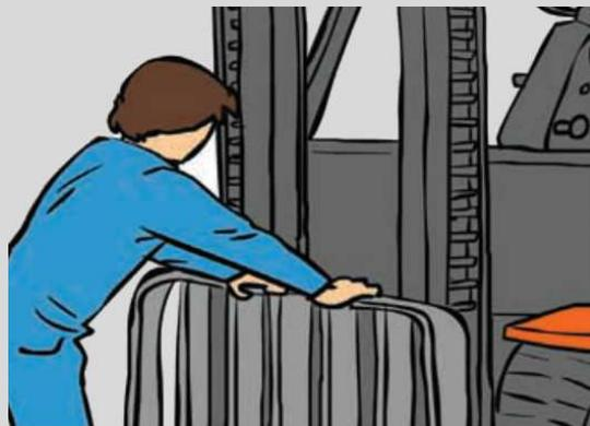
L'existence de fissures ou de déformations dans le dossieret de charge.
