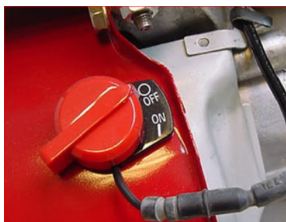
Figura 9 Controlo do motor
