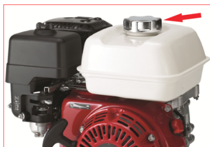
Figura 16 Tapa del depósito de combustible
