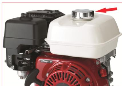
Image 16: Bouchon du réservoir de carburant
