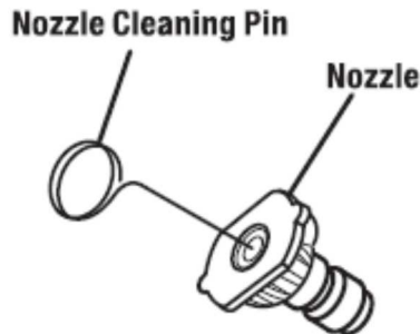
Nozzle cleaning pin – Anilla de limpieza de la boquilla nozzle – Boquilla
